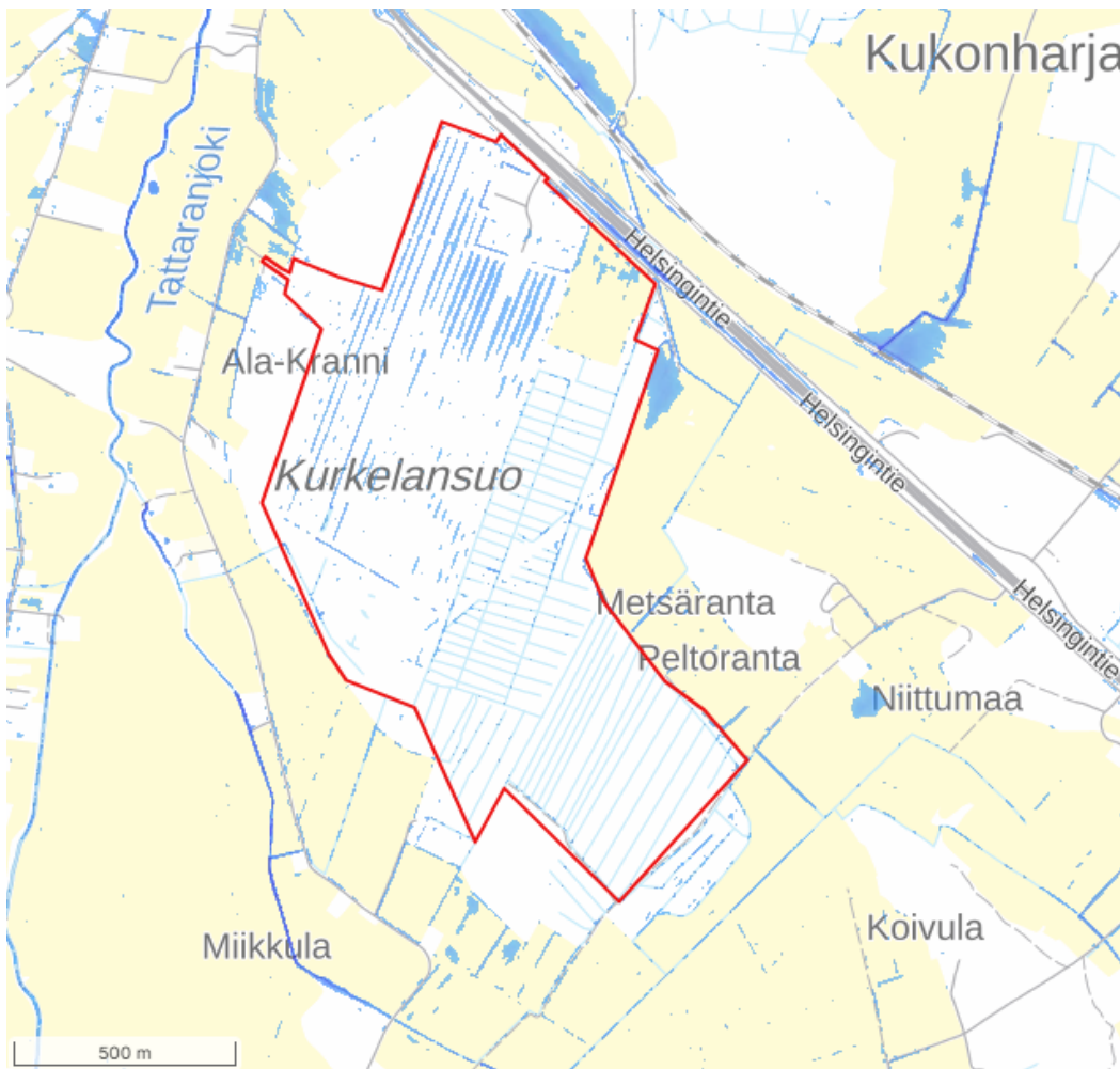
Kuva 8 Rankkasateen aiheuttama veden lätäköityminen hankealueella (ScalgoLive, MML)
