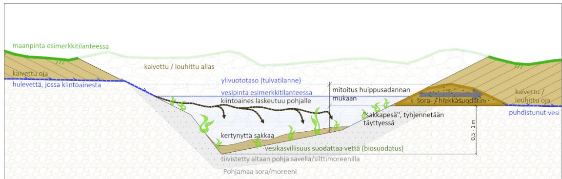
Kuva 13. Tyypik kuva hulevesialtaan poikkileikkauksesta (Taratest Oy).
