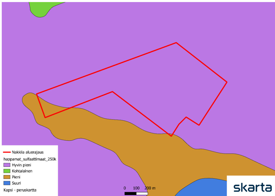
Kuva 17. Happamat sulfaattimaat hankealueella
